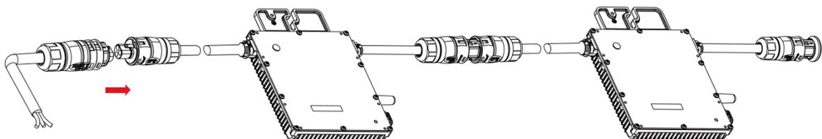
C) Schließen Sie die andere Seite des AC-Endkabels an den Verteilerkasten an und verbinden Sie es mit der hausinternen Installation.
