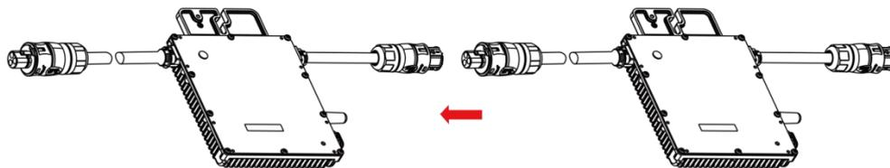
\* Anmerkung: Die Länge des AC-Kabels am Mikrowechselrichter beträgt etwa 1,23m. Wenn der Abstand zwischen zwei Mikrowechselrichtern mehr als 1,21m beträgt, so verwenden Sie bitte ein AC-Verlängerungskabel zwischen den beiden Mikrowechselrichtern (wie in der Abbildung unten dargestellt).
